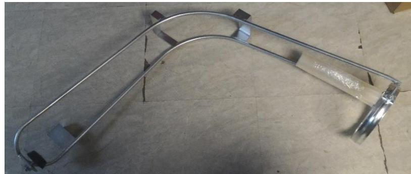
Console pour capteur sick MHT1-P122 (RP45206)
